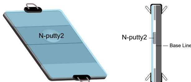
高温試験終了後、材料は元の位置からずれるかを確認する
